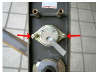
19.抜き取ったシリンダーです。形状を確認したら、この部分をリプレイスシリンダーと交換して、後は、外した時と逆の手順で取付できます。これで全作業終了です。お疲れ様でした。
