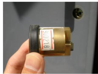
27.手順26で確認した向きに新しいシリンダーを取り付けます。手順24で外したカバーを新しいシリンダーへ入れ替えて取付けします。
