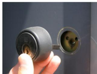
13.取外した既存のシリンダーをシリンダーカバーから抜きます。新しいシリンダーを既存のシリンダーカバーに入れ替えて取替作業を行います。
