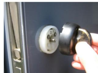
9. サムターンを外して出てきた内部の部品です。プラスドライバーを使って、2本のネジを緩め外します。
