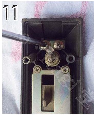
固定ネジをプラスドライバーで外していきます。画像は、室外側ハンドルの上部シリンダーです。
