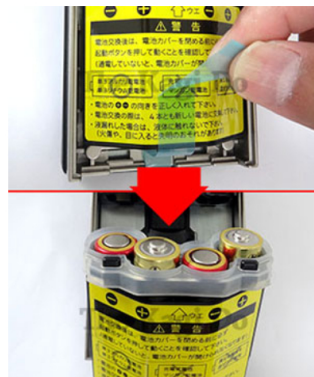
5. 電池ケースに張り付いているシールを剥がし、電池を入れ取付け直しして下さい。
