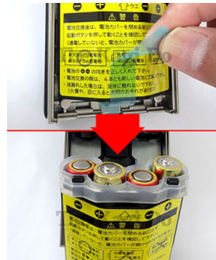
5. 電池ケースに張り付いているシールを剥がし、電池ケース下側に指をかけ外し、電池を入れ取り付けし直して下さい。
