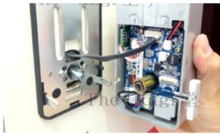
53.商品付属の「M3×5 特皿ネジ」を準備し、ボディの側面を留め付けて下さい。
