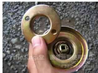
13.マルチロック取替玉座室外側ノブを取付けます。8.の中心のスピンドルの溝の向きに注意して下さい。また鍵穴のマルチロックのマークマッスルマンがまっすぐ向くようにして下さい。
