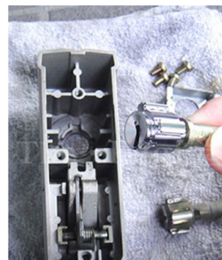
6. 次に、室外ハンドル裏面から上下シリンダーを外していきます。ハンドル上部から4ヶ所の固定ネジをプラスドライバーで外します。
