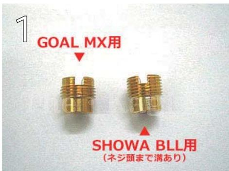
WEST シリンダーへの交換です。WEST の商品に付属する、画像の部品で、MX 用のものを用意して下さい。
