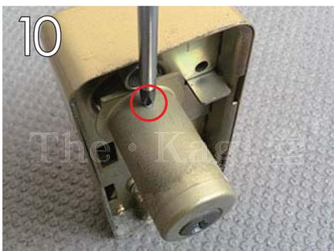
シリンダーの交換は、箱錠本体の印のネジを1カ所外します。小さめのドライバーが必要な場合もございます。
