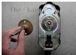
15.先ほどのプレートを外したら、外側シリンダーを反時計回りに回します。
