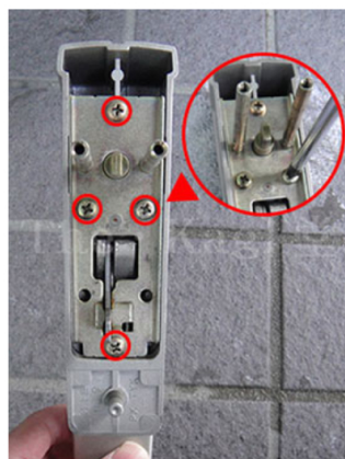
6. 次に、室外ハンドル裏面から上下シリンダーを外していきます。ハンドル上部から4ヶ所の固定ネジをプラスドライバーで外します。
