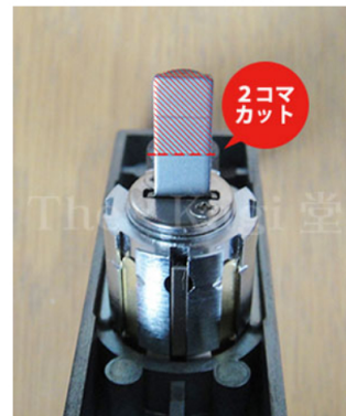
6. 外部長座のドライバーから調整していきます。「扉厚部品選定表」ではドライバーの外側から「2コマカット」になります。
