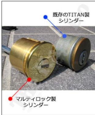
10. 次に、交換用のシリンダーを取付けていきます。図の奥のシリンダーが既存のもので、手前のマルティロック製のシリンダーに交換していきます。
