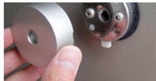
13.ネジを緩め、取り外せばサムターンが取り外せます。この際に外側シリンダーが外れますので手でシリンダーを押さえながら作業をして下さい。
